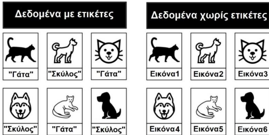
Σχήμα 2. Η μηχανική εκμάθηση μπορεί να χρησιμοποιεί περιορισμένο αριθμό δεδομένων με ετικέτες ή τεράστιο αριθμό δεδομένων χωρίς ετικέτες.
